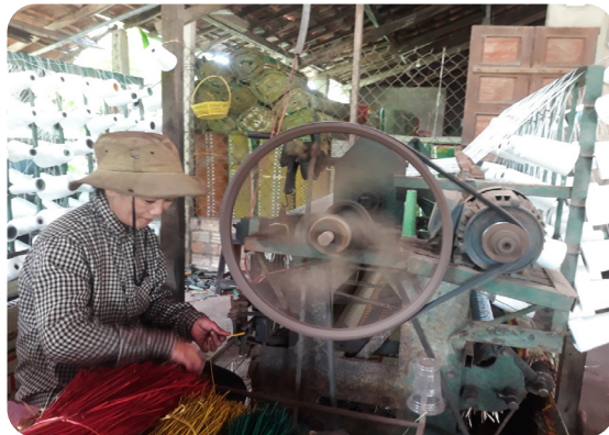
Hình 4.6. Dệt chiếu (sử dụng máy dệt)
