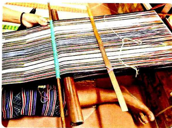
Hình 17. Công đoạn se chỉ vào khung
